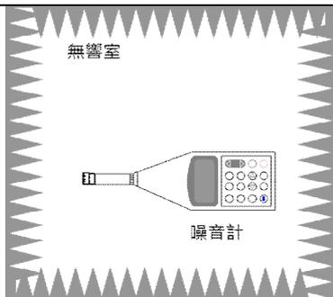
圖 2 噪音計聲訊號自雜訊測試
