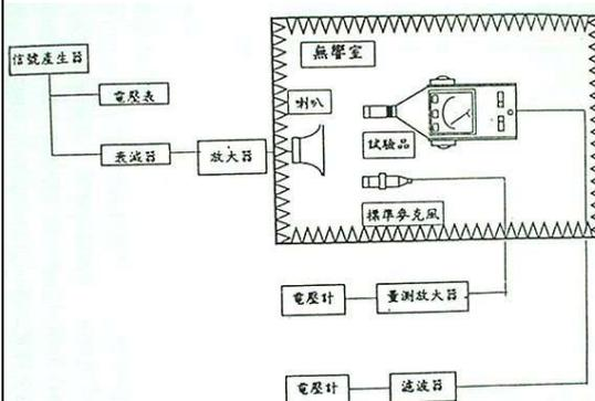
噪音計的器差測試系統圖
