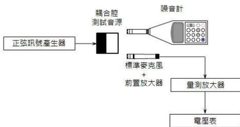
圖 5 噪音計聲訊號頻率加權檢測系統
