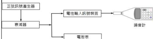
圖 7 噪音計位準線性度檢測系統
